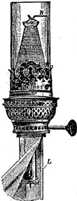
Abb. 49. Der Auer'sche Glühstrumpf.
