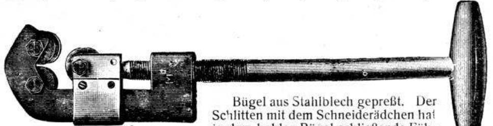
Bügel aus Stahlblech gepreßt. Der Schlitten mit dem Schneiderädchen hat in dem hohlen Bügel schließende Führung, wodurch derselbe unbedingt gerade vorgeschoben wird und ein Schief- oder sogenanntes Gewindeschneiden ausgeschlossen ist.
