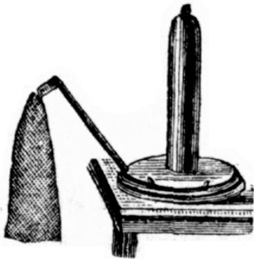
den Haken sammt dem daran hängenden Netze in ein Loch, welches in einer Holzleiste oder im Fuße der Form selbst eingelassen ist, und beginnt dann das Abbrennen, indem man gegen den Kopf des Netzes die starke Flamme eines Bunsenbrenners richtet. Man läßt die Flamme immer auf den Kopf des Netzes wirken. Binnen Kurzem bildet sich ein bren-
